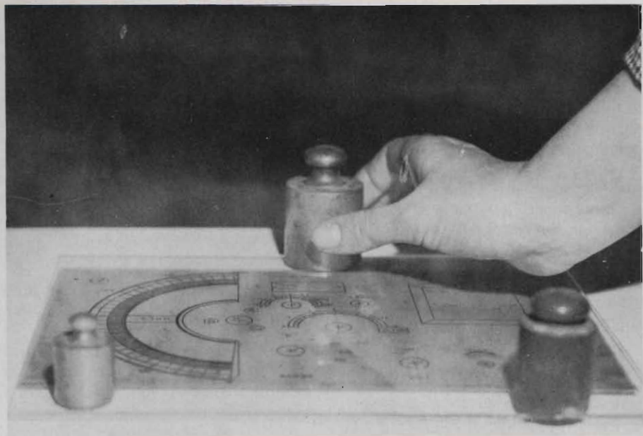
Fig. 3 - Per ottenere fotografie nitide, il disegno e la lastra metallica vanno fatti aderire perfettamente fra loro sovrappo- ndovi un cristallo caricato con pesi.
